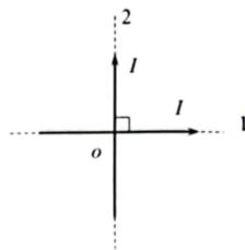
**解** 导线 2 产生的磁感应强度为  $\frac{\mu_0 I}{2\pi r}$ , 方向垂直纸面向里 ( $r > 0$ ) 或向外 ( $r < 0$ )
