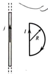
**解** 均匀载流无限大平板在右侧附近产生的磁感应强度为  $\frac{\mu_0}{2} j$ , 方向垂直纸面向里
